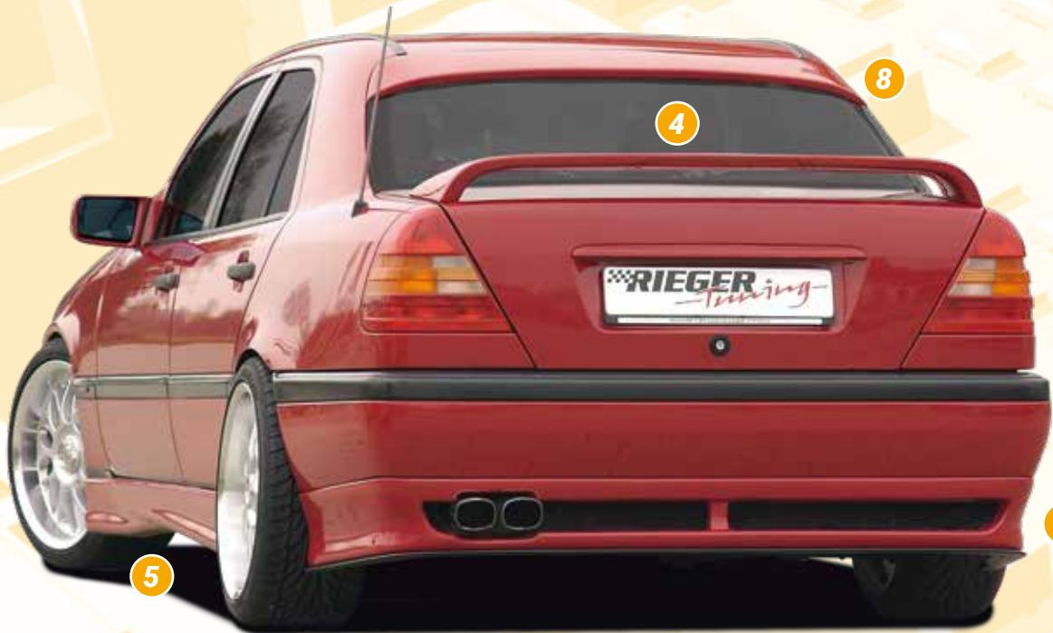
Bei dem Heckflügel ohne Bremsleuchte ist anstatt der Leuchte eine Adapterplatte montiert.
