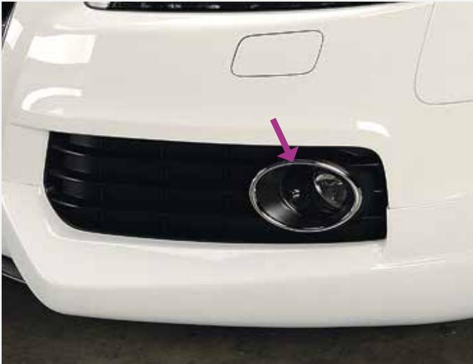
Bei S-Line befindet sich der Nebelscheinwerfer **direkt in** der Abdeckung.
